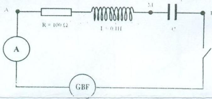
Le schéma ci-dessus est celui d'un circuit électrique alimenté par un générateur de basse fréquence qui délivre une tension alternative sinusoïdale de fréquence 50Hz et valeur efficace  $U=96V$ . Lorsque le circuit est fermé, l'ampèremètre de résistance négligeable, indique 0,7A.
